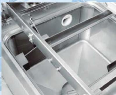
Le vasche sono vuotate automaticamente premendo un solo pulsante, senza l'intervento manuale dell'operatore.
