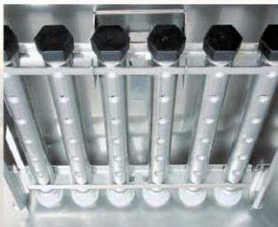
La zona di lavaggio principale è equipaggiata con **6 bracci di lavaggio superiori e 4 inferiori**. Alimentati della Potenza della pompa, assicurano il massimo tempo di contatto dei piatti durante l'azione di lavaggio. Getti di lavaggio concavi per evitare otturazioni e tubi in acciaio inox, garantiscono un lavaggio perfetto i modo costante.
