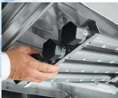
Il monoblocco dei bracci di lavaggio può essere facilmente rimosso per la pulizia, senza l'utilizzo di utensili. Per riposizionarlo scorre nelle proprie guide e raggiunge la propria posizione. Solo i tappi di testa ai bracci di lavaggio devono essere smontati per la loro pulizia, ma è un'operazione estremamente semplice.
